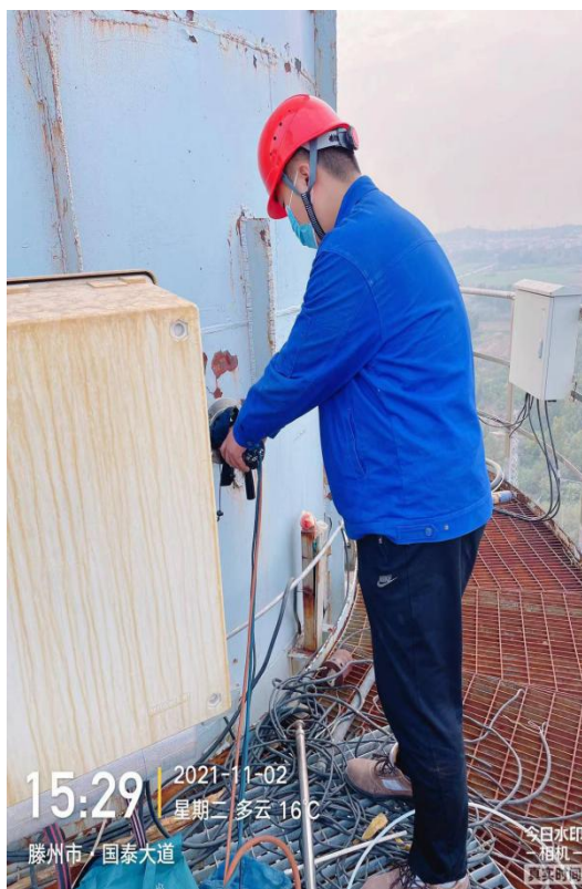
西厂区锅炉排气筒采样口
