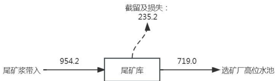
图 2.7-1 本项目现状水平衡图（单位： \text{m}^3/\text{d} ）
