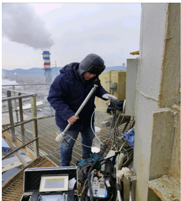
图4.1-7 西厂区锅炉排气筒采样平台、采样口
