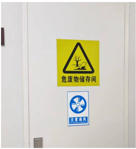
图 3-11 危险废物贮存场所标识牌
